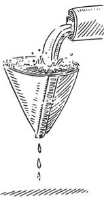
Consiste en separar una mezcla de un sólido y un líquido. Se deposita en una coladera o papel filtro para que el componente sólido se quede en el filtro y el líquido pase. Este método de separación es muy común para eliminar los contaminantes del agua.
